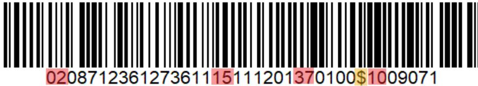
Il barcode è costruito tramite l'uso di identificatori di applicazione (Application Identifiers AI) che permettono di concatenare nello stesso codice diverse informazioni:
