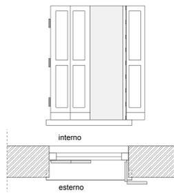
ESEMPI DI FINESTRA SENZA RIQUADRI E CON ANTE DI OSCURO ESTERNE IN LEGNO, RIPIEGABILI A LIBRO A SPECCHIATURA CIECA FORMELLATA A DUE O PIU' RIQUADRI CON FERRAMENTA DI SOSTEGNO E MANOVRA IN FERRO (scala 1:20)
