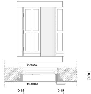
ESEMPI DI FINESTRA CON RIQUADRI IN PIETRA ED ANTE DI OSCURO ESTERNE IN LEGNO, RIPIEGABILI A LIBRO A SPECCHIATURA CIECA FORMELLATA A DUE O PIU' RIQUADRI CON FERRAMENTA DI SOSTEGNO E MANOVRA IN FERRO (scala 1:20)
